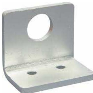
Il faut réaliser deux trous à la base et un trou  $\varnothing 10\text{mm}$  pour l'axe du potentiomètre. Le centre de ce trou doit être placé à la même hauteur que celui pratiqué sur la face AV, soit 40mm depuis le fond du boîtier.
