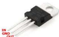
Le reste est simple : on pliera la borne "out" du 7805 à 90° vers le haut et on y soudera une résistance d'1 kOhms pour alimenter l'anode de la LED, la cathode étant branchée à la masse. On coupera à la bonne longueur les pin "IN" et "GND" du régulateur que l'on insèrera respectivement dans le bornier vissant à la sortie +12 et la masse.
