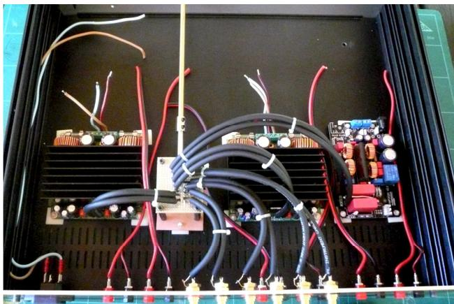
On procède de la même façon pour fixer les alimentations SMPS 500 : agrandissement des trous de fixation et usage des clips adhésifs. Seule la Meanwell RS50 ne peut être fixée avec les clips et il a été utilisé à la place un simple ruban de mousse adhésive double face.
