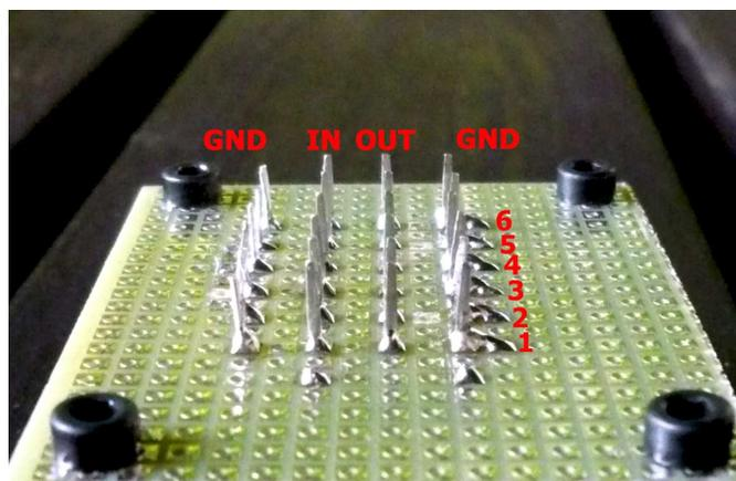
Le câblage du potentiomètre est simple, de l'avant vers l'arrière : IN1 entrée aigu gauche, IN2 entrée aigu droit, IN3 entrée médium gauche, IN4 entrée médium droit, IN5 entrée grave gauche, IN6 entrée grave droit.
